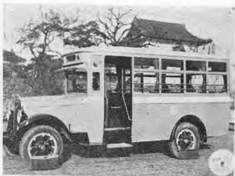
震災後の東京市営バス、シボレー車 に架装された欄間付のもの
