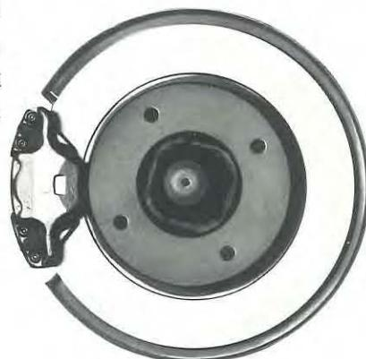
前輪にディスクブレーキ、後輪に大型ドラムブレーキを装備。どんな条件のもとでも制動距離が非常に短く、ドライバーひとりの場合でも、定員全部が乗っている時でも、
