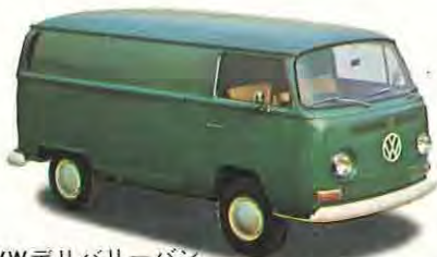
VWデリバリーバン 1600cc 46馬力(DIN)/4400r.p.m. 最高巡航速度110km/h
