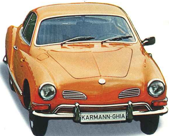
おしゃれなフォルクスワーゲン VWカルマンギヤクーペ/オートマチック 1600cc 60馬力/4400r.p.m. 最高巡航速度 138km/h(オートマチック; 134km/h)
