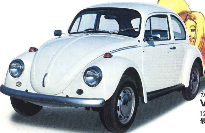
実用的なかぶと虫 VW1300セダン 1300cc 52馬力/4600r.p.m. 最高巡航速度 125km/h
