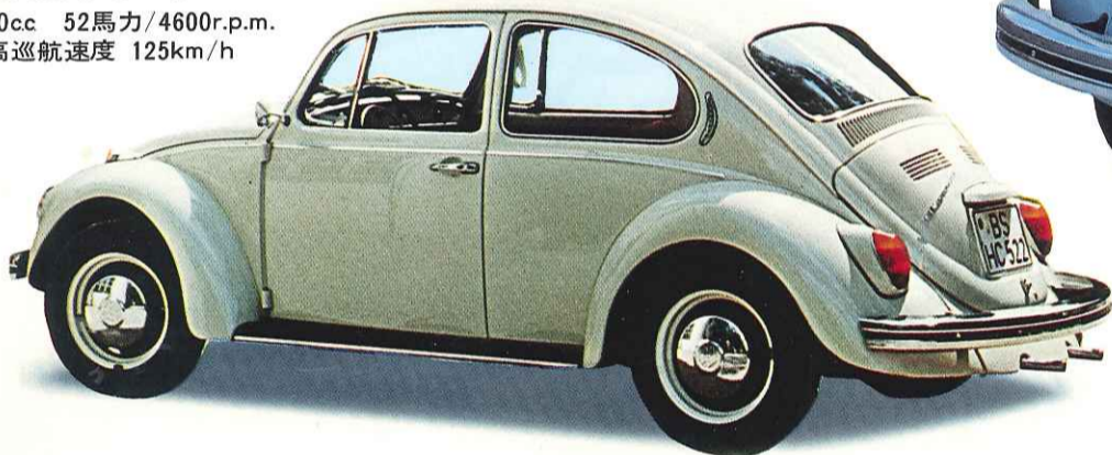
ハイウェイ時代のかぶと虫 VW1302セダン 1300cc 52馬力/4600r.p.m. 最高巡航速度 125km/h
