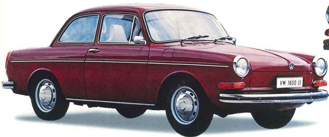
風格あふれるフォルクスワーゲン VW1600LE/TLEセダン/オートマチック 1600cc 65馬力/4600r.p.m. <コンピューター付燃料噴射エンジン> 最高巡航速度 135km/h(オートマチック; 130km/h)
