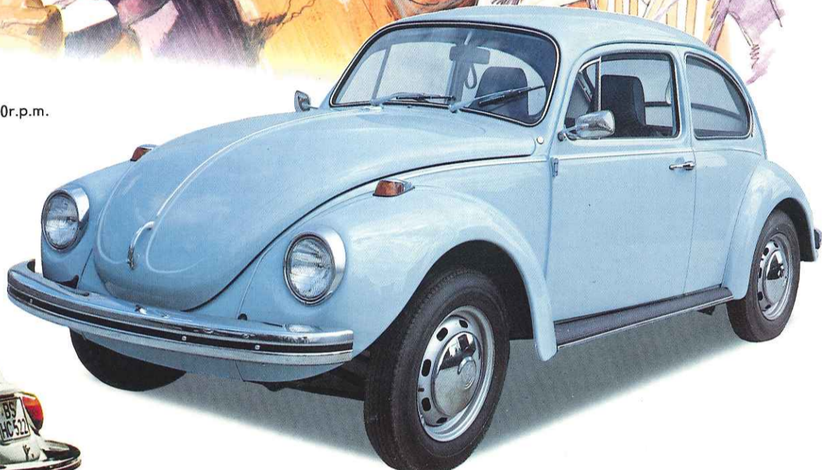
ハイウェイ時代のかぶと虫 VW1302セダン 1300cc 52馬力/4600r.p.m. 最高巡航速度 125km/h
